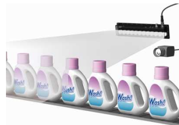
ボトルキャップの外観検査
