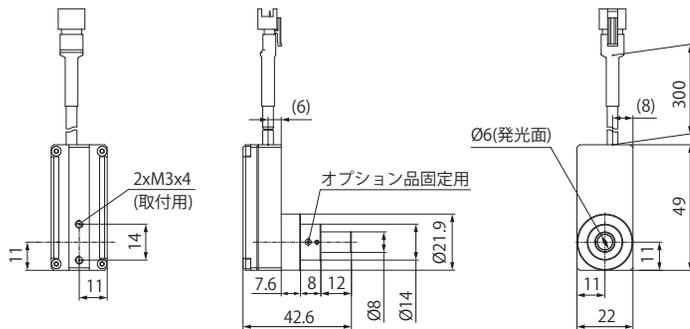
発光先端径  $\varnothing 12$  モデル HLV3-22-2-1220
