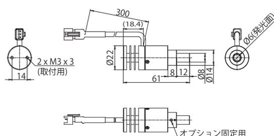
発光先端径  $\varnothing 12$  モデル HLV3-22-2C-1220
