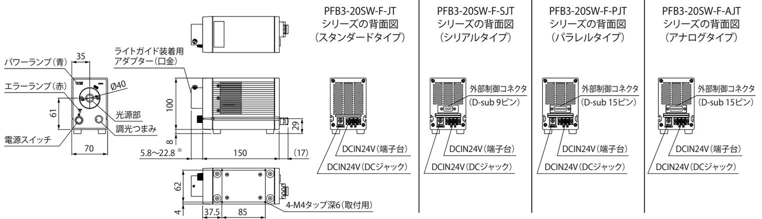
※ご使用になるライトガイドによって、接続部の装着用アダプター(口金)の寸法が変わります。詳しくは、ライトガイド装着用アダプター寸法表をご参照ください。
