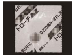
ドーム照明+同軸照明での撮像 (HPD2-250BL+LFV3-70BL)
