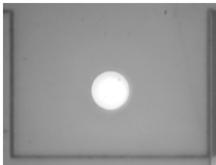
液晶の張り合わせ工程で認識されるアライメントマーク
