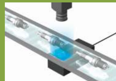
・プラグの電極ギャップ撮像
