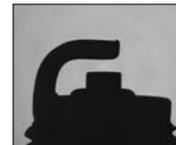
通常、寸法計測では安定して撮像できるバックライトが多用されますが、平行度の高いライティングを施せば、さらに精度の高い寸法測定が可能となります。
