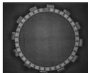
クラッチ板の異物・傷・寸法検査などでは、直射光リングタイプのローアングル照明を用いることで、暗い視野での検出が可能になります。
