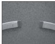
同軸照明を用いて金属表面を均一に照射すれば、ピストンリングの文字・寸法・異物判別検査がハイコントラストで可能となります。
