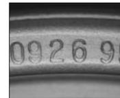
ホイールに刻印されてあるロットナンバーは、塗装色や刻印部分が多岐にわたるため、柔軟な対応ができる直射光バータイプで文字を浮かび上げさせます。
